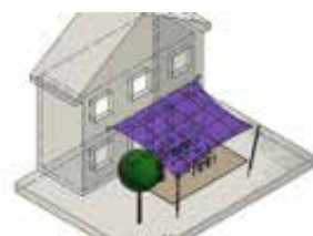
E2 2 x mastoja 2 x seinäkiinnitystä (Seinäkiinnikkeet)
