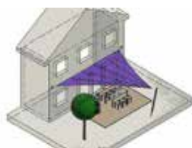
E1 1 x masto 2 x seinäkiinnitystä (Seinäkiinnikkeet)
